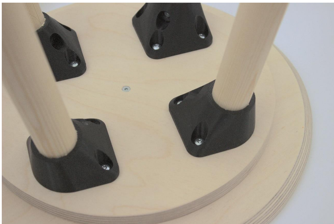
Kuva 10. 3D-tulostetut kiinnikkeet kiinnitettyinä ruuveilla jakkaran pohjaan
