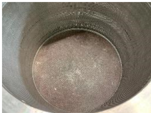
Kuva 10. Lankarakosihti 0,20 mm raolla, langan leveys 4 mm ja profiilin korkeus 0,60 mm.
