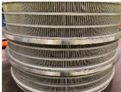
Kuva 11. Kuvan 8 sihti ulkopuolelta kuvattuna, lankojen kiilamaisuus erottuu.
