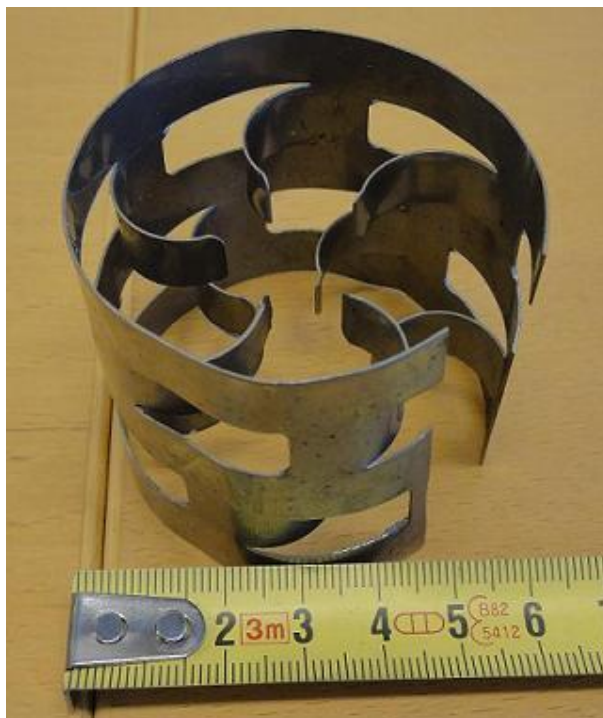
KUVA 5. Satulaattorin täytekappale Hintan vedenpuhdistamolla
