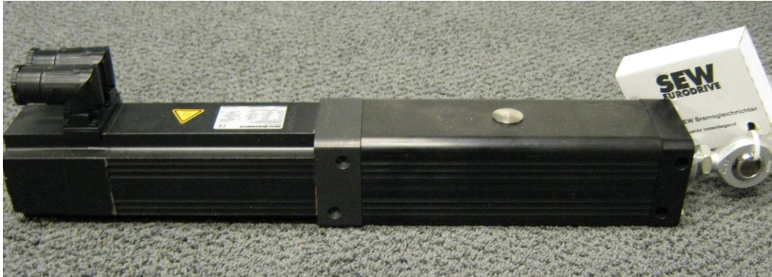
KUVA 13. Flotaatioaltaan säätöpadon uusi nostin
