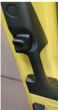
KUVA 2. Ambulanssin sivuoven aukaisupainike (Kuva: Toivola 2021)
