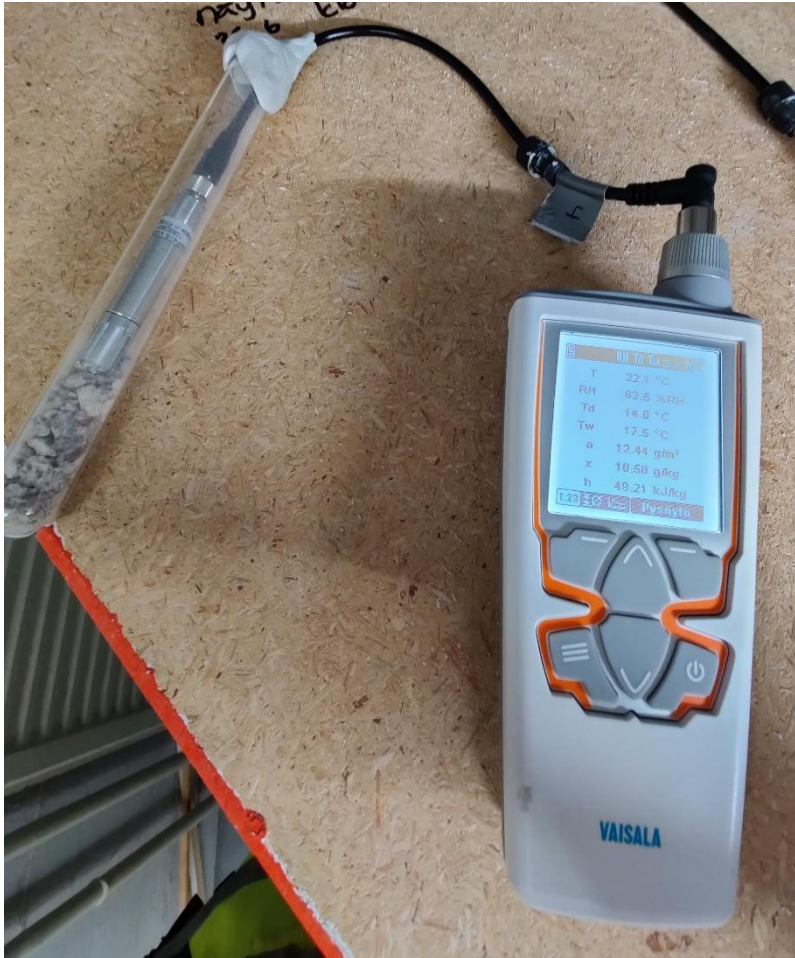
Kuva 8. Mittausten luku näytepalamenetelmällä Vaisalan mittarilla.
