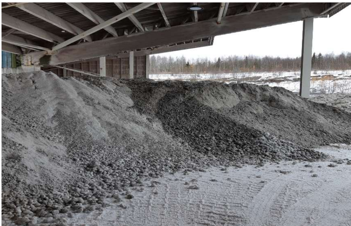
KUVA 6. Suolasaostuman ja kipsin valmis seos kahden vuoden suoloista valmiina kierrätykseen.
