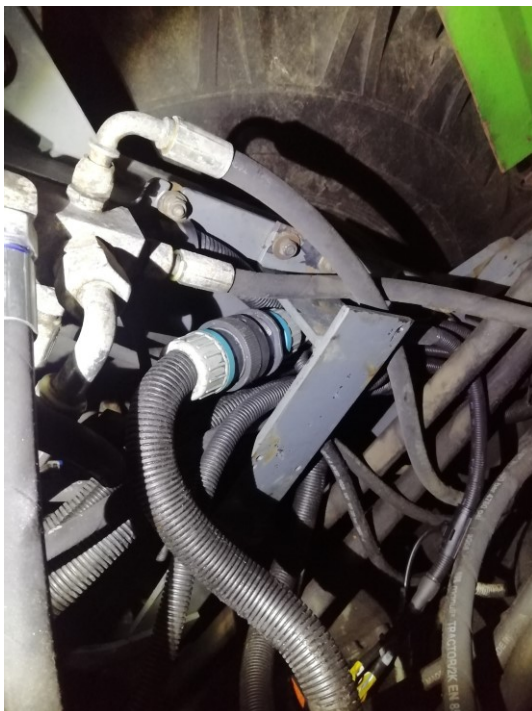
Kuva 21. Adapterijohdinsarjan ja koneen alkuperäisen johdinsarjan välisen liitoksen sijoitus niin, että se olisi tukevasti kiinnitettävissä ja suojassa.
