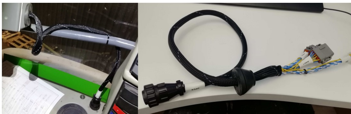
Kuva 16. Suojapunosta johdinsarjan suojaamiseen ohjaamossa.
