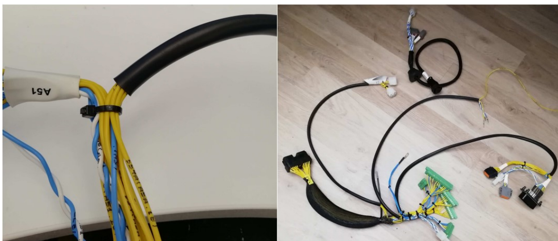
Kuva 15. Ohjaamon johdinsarjan suojaamiseen käytetty PVC-letku.
