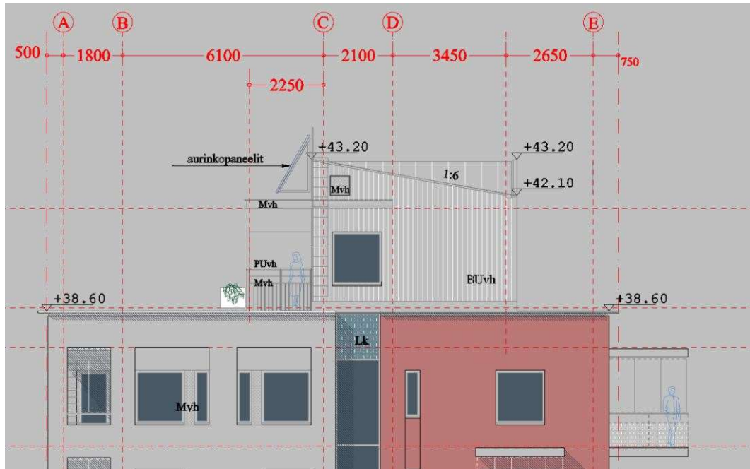
Kuva 13. Esimerkkikohteen paneelien kiinnitys rakennuksen seinään terassin katon päälle
