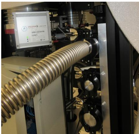
Kuva 62. Vuototesteri liitettynä Gas Handling Systemiin
