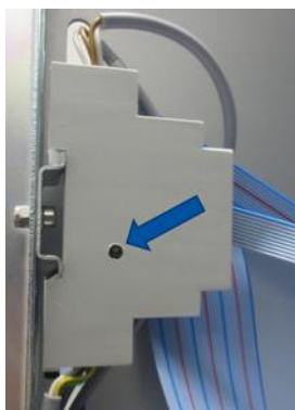
Kuva 5. Virtausmittarin säädin merkattuna nuolella
