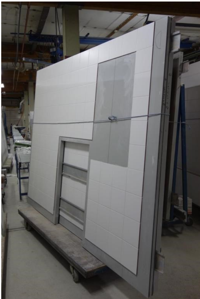
Kuva 11. Teräsohutlevystä valmistettu seinäelementti, johon on seinälaatoitus suoritettuna valmiiksi. Seinälaatoitus jätetään tekemättä kylpyhuonekalusteiden takapuolelta. (Sandström, 2019: 7.)
