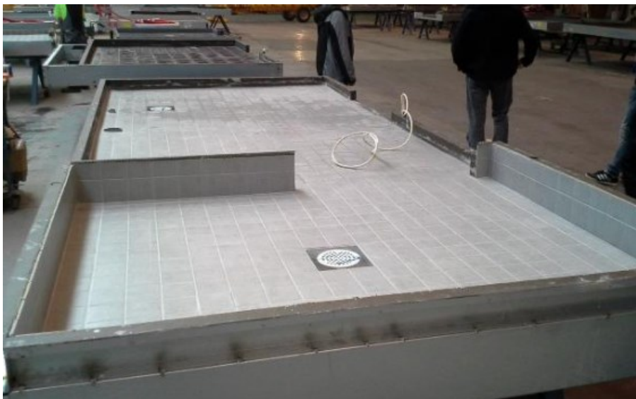
Kuva 10. Kylpyhuone-elementin pohjalaatta laatoitettuna valmiiksi. (Sandström, 2019: 6.)
