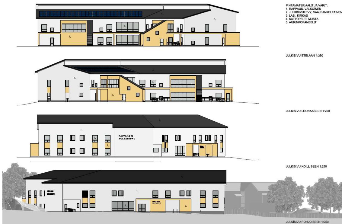
Kuva 11. Päiväkodin julkisivupiirustukset. (Viitanen 2021)
