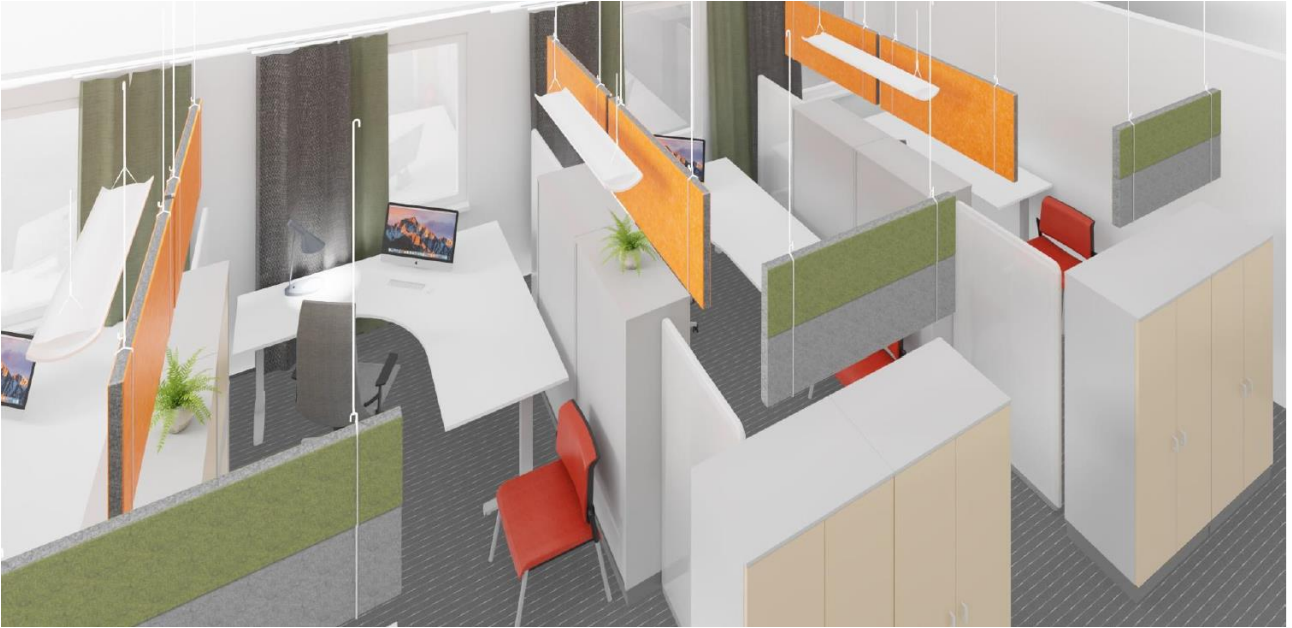
Kuva 12. Ehdotus Pa-Ri Materian ratkaisusta tuotehallinnan akustiikkapaneeleista (Pa-Ri Materia 2021)
