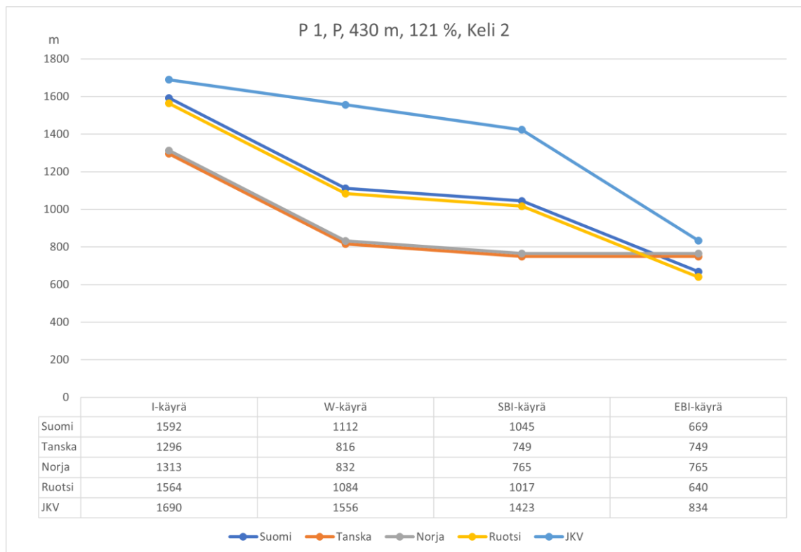
Kuva 22. Junan P1 jarrukäyrät ETCS- ja JKV-laskentatyökaluilla laskettuina. ETCS normaali kelin hidastuvuusarvolla ja JKV kelin 2 kertoimella.
