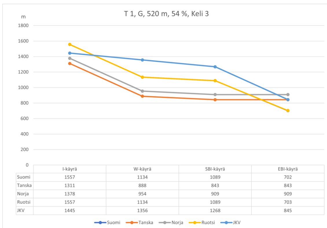
Kuva 27. Junan T1 jarrukäyrät ETCS- ja JKV-laskentatyökaluilla laskettuina. ETCS liukkaan kelin hidastuvuusarvolla ja JKV kelin 3 kertoimella. Suomen ja Ruotsin kuvaajat kulkevat päällekkäin kuvassa.
