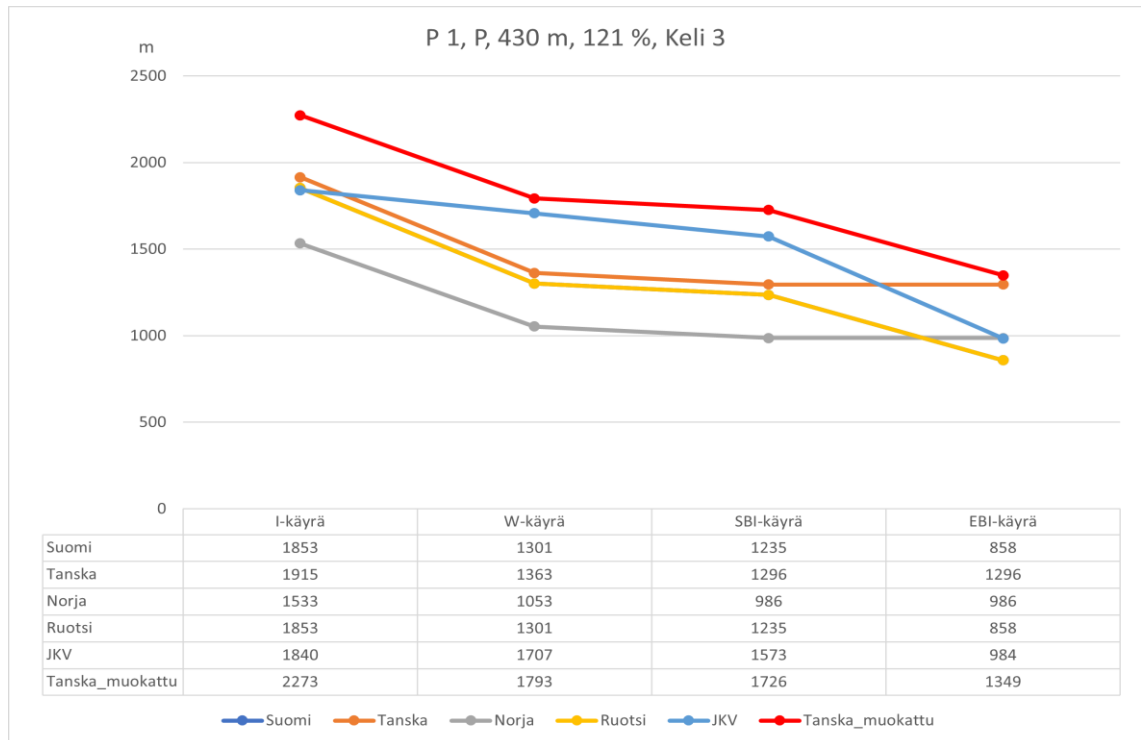
Kuva 23. Junan P1 jarrukäyrät ETCS- ja JKV-laskentatyökaluilla laskettuina. ETCS liukkaan kelin hidastuvuusarvolla ja JKV kelin 3 kertoimella. Suomen ja Ruotsin kuvaajat kulkevat päällekkäin kuvassa.
