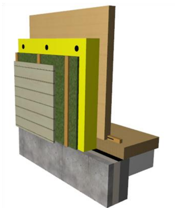
Kuvio 6. Liittäminen perusmuuriin ja kantavaan alapohjaan (3D-kuva)
