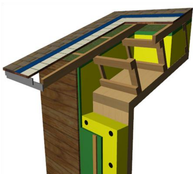
Kuvio 27. CLT-levy yläpohjarakenteen alapuolella (3D-kuva)
