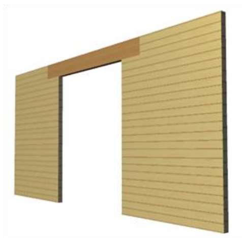
Kuvio 35. Aukkopalkin liittäminen CLT-seinään (3D-kuva)
