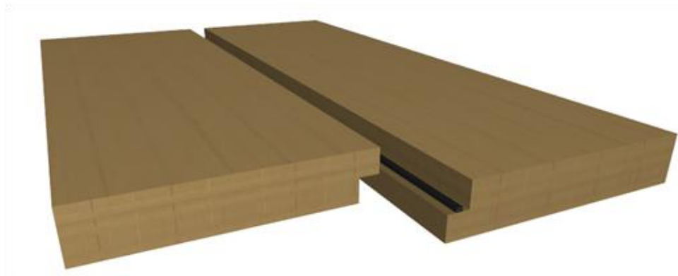
Kuvio 14. CLT-levyjen puoliponttiliitos (3D-kuva)
