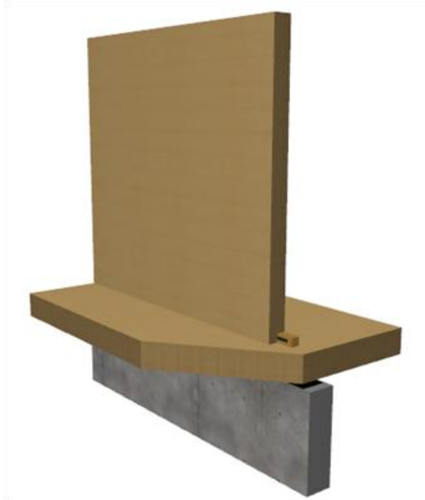
Kuvio 10. CLT-väliseinän liittäminen kantavaan alapohjaan (3D-kuva)
