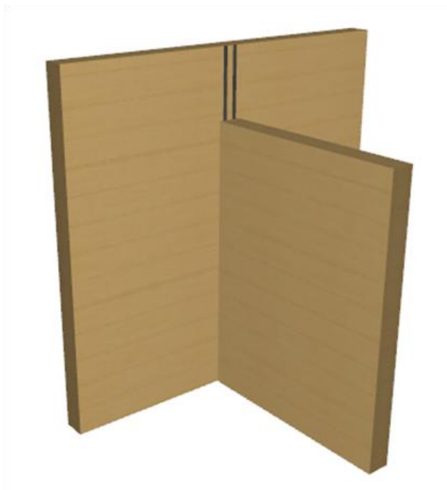
Kuvio 18. CLT-väliseinän liittäminen (3D-kuva)
