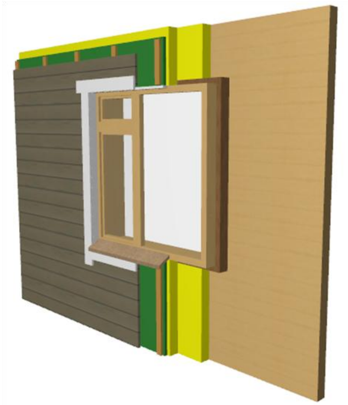
Kuvio 31. Ikkunan liittäminen CLT-rakenteiseen seinään (3D-kuva)
