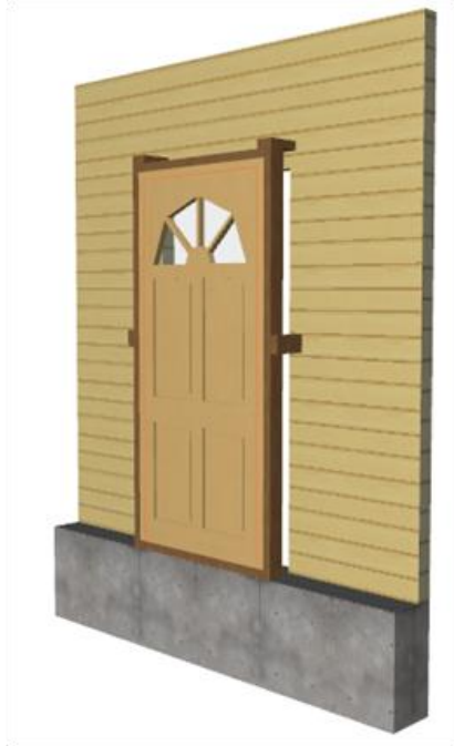
Kuvio 33. Oven kiinnittäminen CLT-seinälevyyn (3D-kuva)
