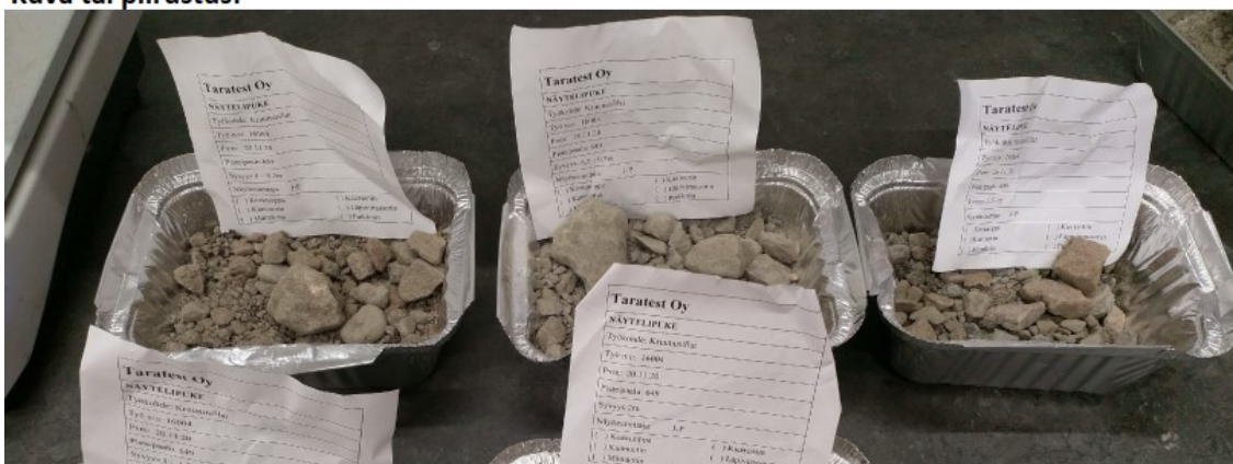
Kuva 14. Kruunusillat-hankkeen koekuopan tulokset Koirasaarentien rakennekerroksista paalulaatan osuudelta.
