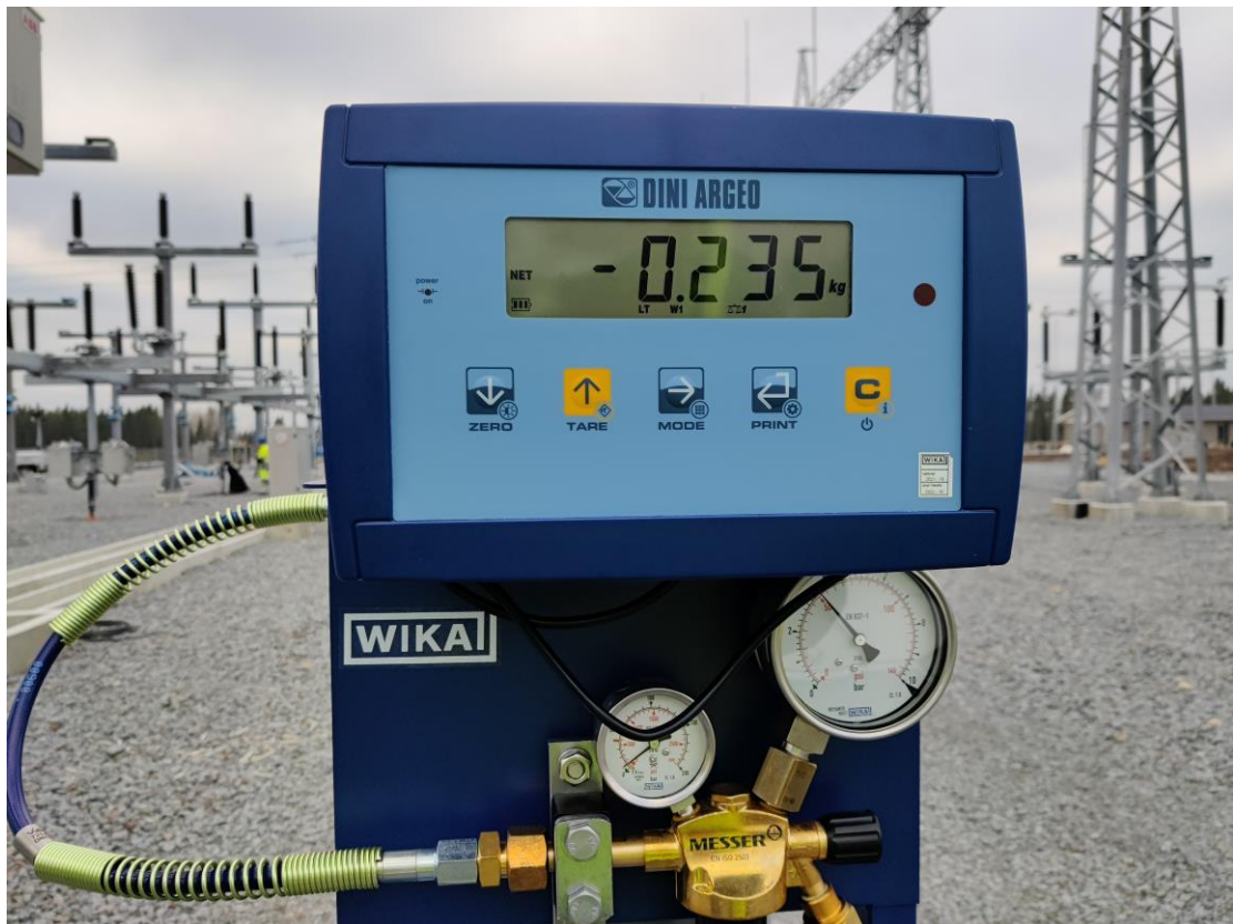
KUVA 6. WIKAI:n kaasutäyttökärryn digitaalinäyttö.
