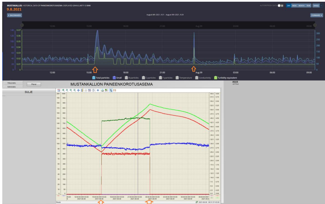
Kuva 10: Mustankallion paineenkorotusaseman pumppujen sammumisen ja käynnistymisen vaikutus veden partikkelimäärään. Kuvan alaosa on näyttökuvaa Insta-automaatio-ohjelmasta. Oranssit nuolet osoittavat samaa ajankohtaa eri palveluissa.
