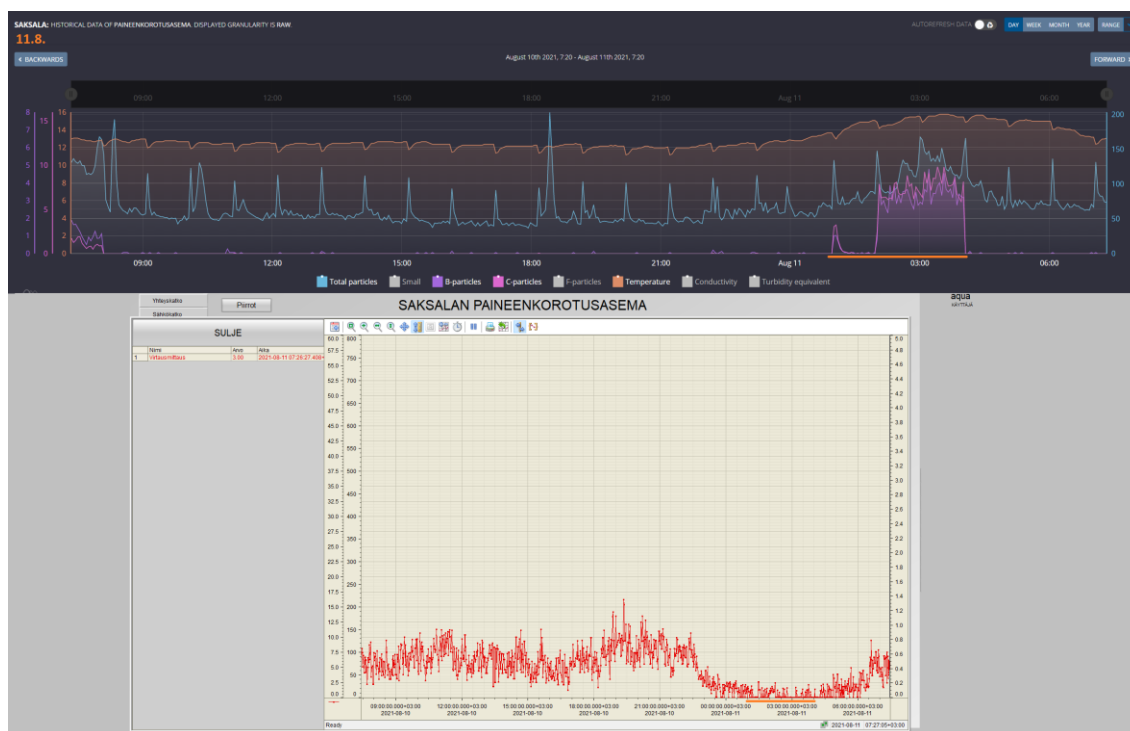
Kuva 11: Virtauksen vaikutus partikkelimäärään Saksalan paineenkorotusasemalla. Kuvan alaosaa on näyttökuvaa Insta-automaatio-ohjelmasta. Oranssi viiva osoittaa samaa ajankohtaa eri palveluissa.
