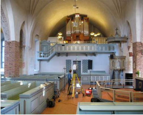
KUVA 2. Laserkeilaimen käyttöä Espoon tuomiokirkossa. Kuva: Pekka Tyni.
