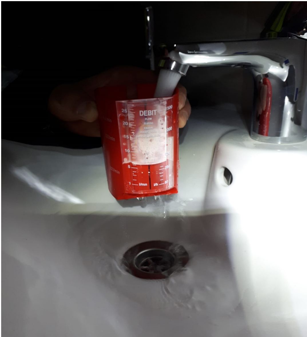
Kuva 23. WC-tilan vesihanavan virtauksen mittaus mitta-astialla, jossa on mittapato.
