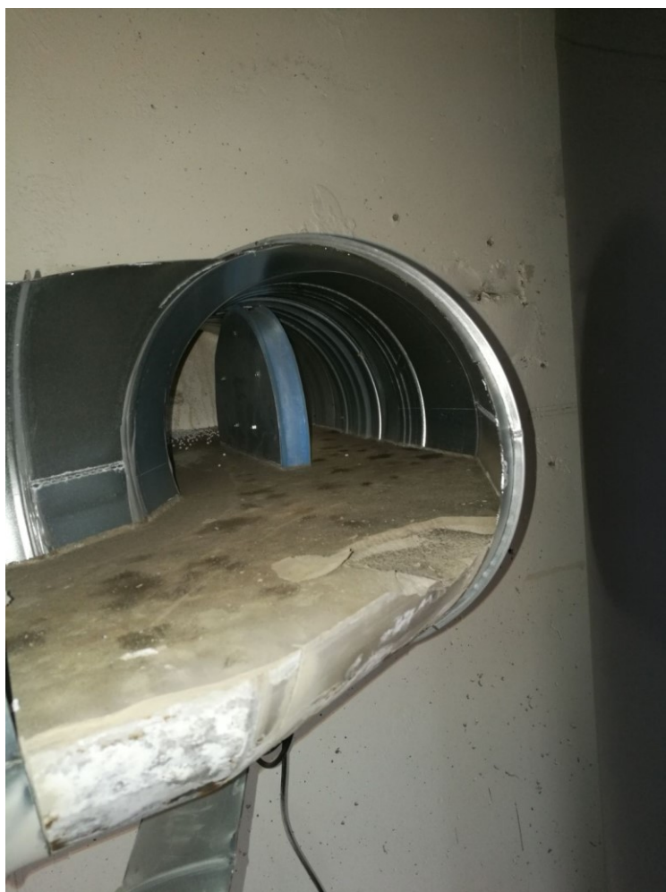
Kuva 15. Palopelti ei sulkeutunut testin aikana.
