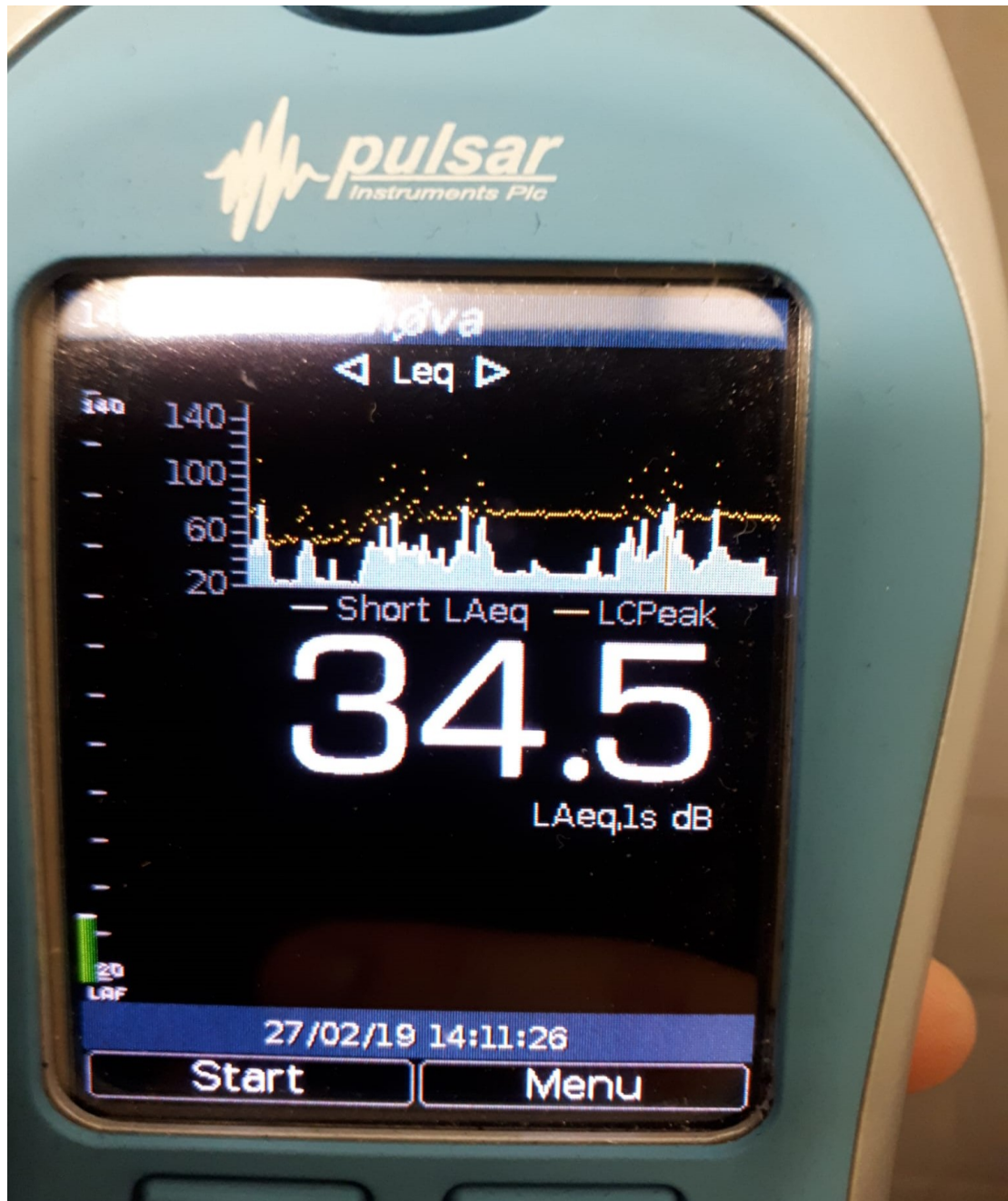
Kuva 17. Äänitasojen mittaukseen käytettävä laite. Kuvanottohetkellä mitattiin likaisten ja WC-tilojen äänitasoja.
