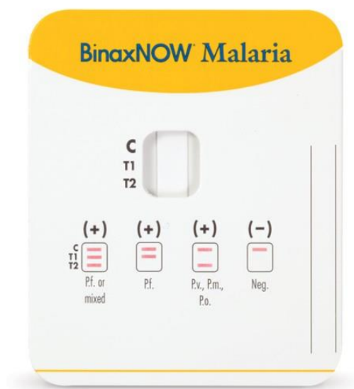
Figur 7. I figuren ser man hur snabbtestet BinaxNOW Malaria ser ut och vilka olika resultat man kan få av testet. (Abbott, u.å.).
