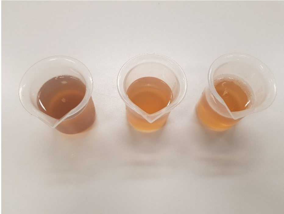
Kuva 6. Saostuskokeen näytteet, vasemmalla sammutettu kalkki, oikealla puujauho ja keskellä vertailunäyte (Kuva: Joonas Kuuramaa).
