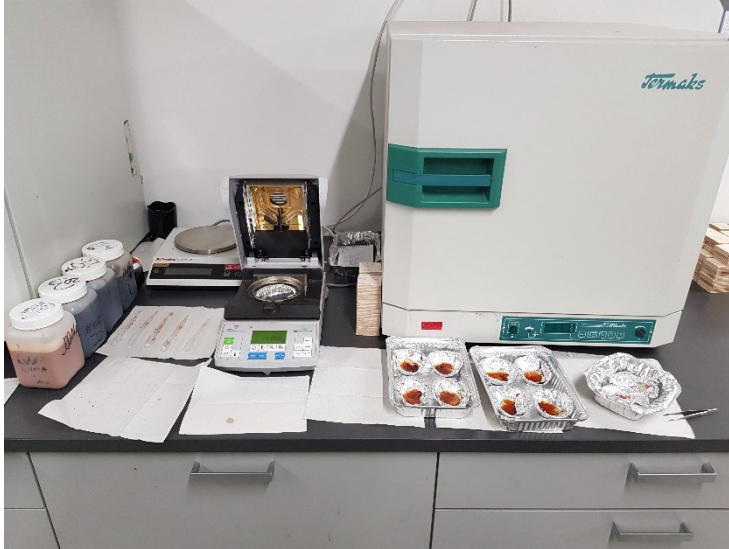
Kuva 18. Kuiva-ainemittauksia vaneritehtaan laboratoriossa (Kuva: Joonas Kuuramaa)
