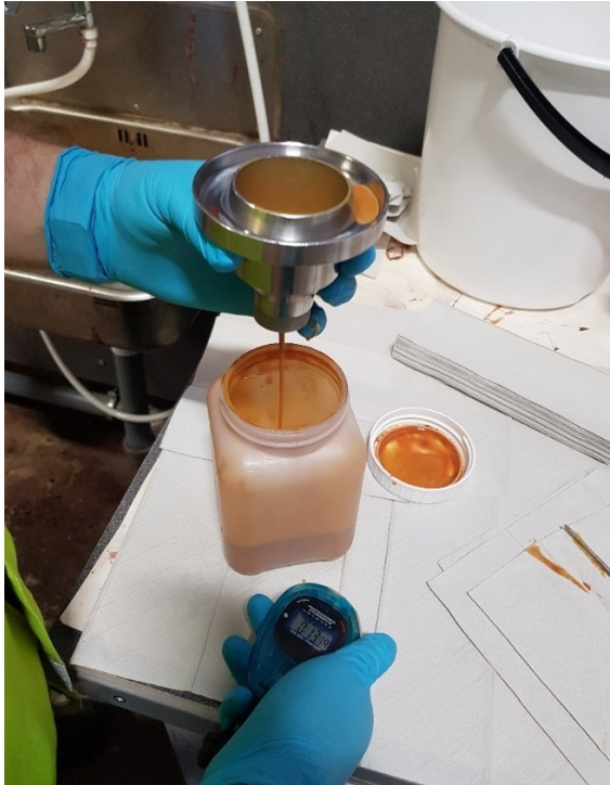
Kuva 19. Viskositeetin mittaaminen tehtaan liimakeittiössä (Kuva: Minna Ahokas)
