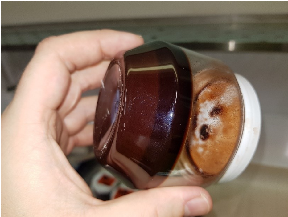
Kuva 4. Veteen liuotetusta liimasta muodostunut mökky näyteastian pohjalla (Kuva: Joonas Kuuramaa).
