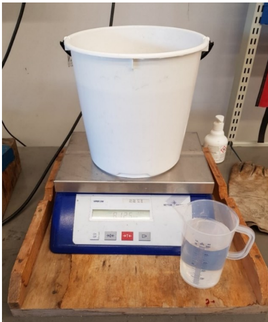
Kuva 8. 8000 gramman liimavesiseoksen valmistus vaa'an avulla Sirkkalassa (Kuva: Joonas Kuurama)
