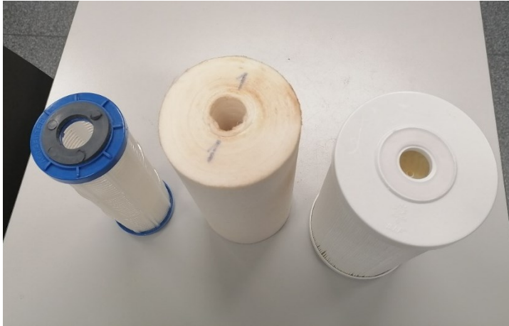
Kuva 10. Tutkimuksessa käytettyjä suodattimia: vasemmalla pestävä kiintoainesuodatin, keskellä hienoainesuodatin ja oikealla UF-suodatin (Kuva: Joonas Kuuramaa).
