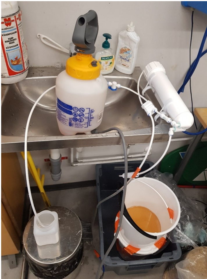
Kuva 12. RO-kalvo käytössä (Kuva: Joonas Kuuramaa).
