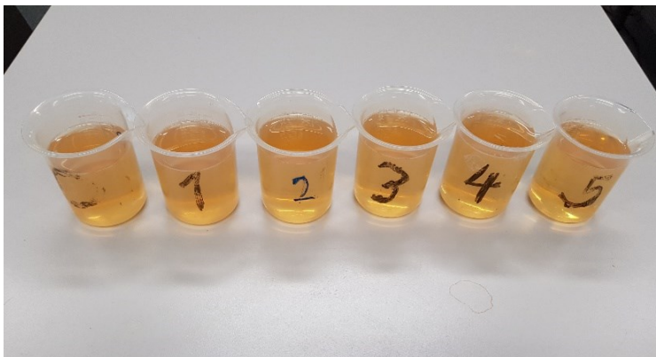
Kuva 14. Suodatettuja PRF-vesiseos näytteitä on vaikea erottaa toisistaan ulkonäön perusteella (Kuva: Joonas Kuuramaa).
