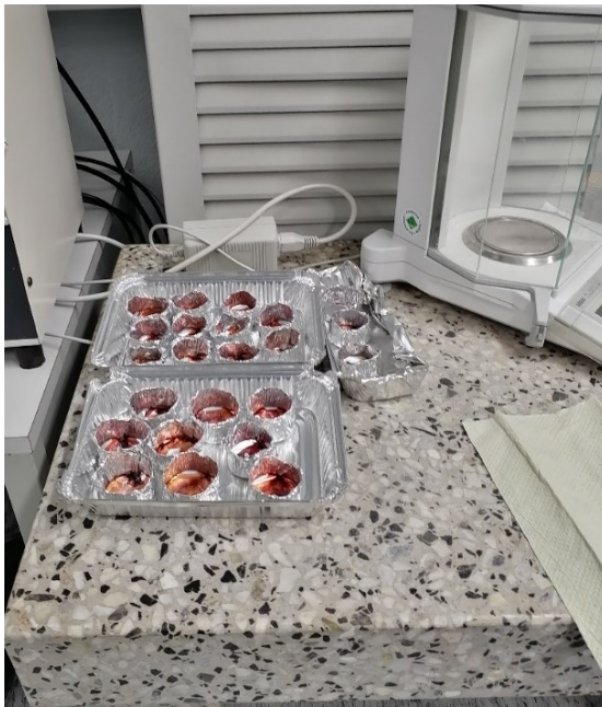
Kuva 17. Kuivatut näytteet punnitsemisen jälkeen (Kuva: Joonna Kuuramaa).
