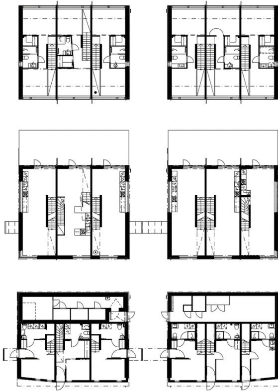
Kuva 34. Violanpuiston townhouset, Snellman & Ahlman, Helsinki, 2010. Uudisrakennusten pohjapiirustukset.
