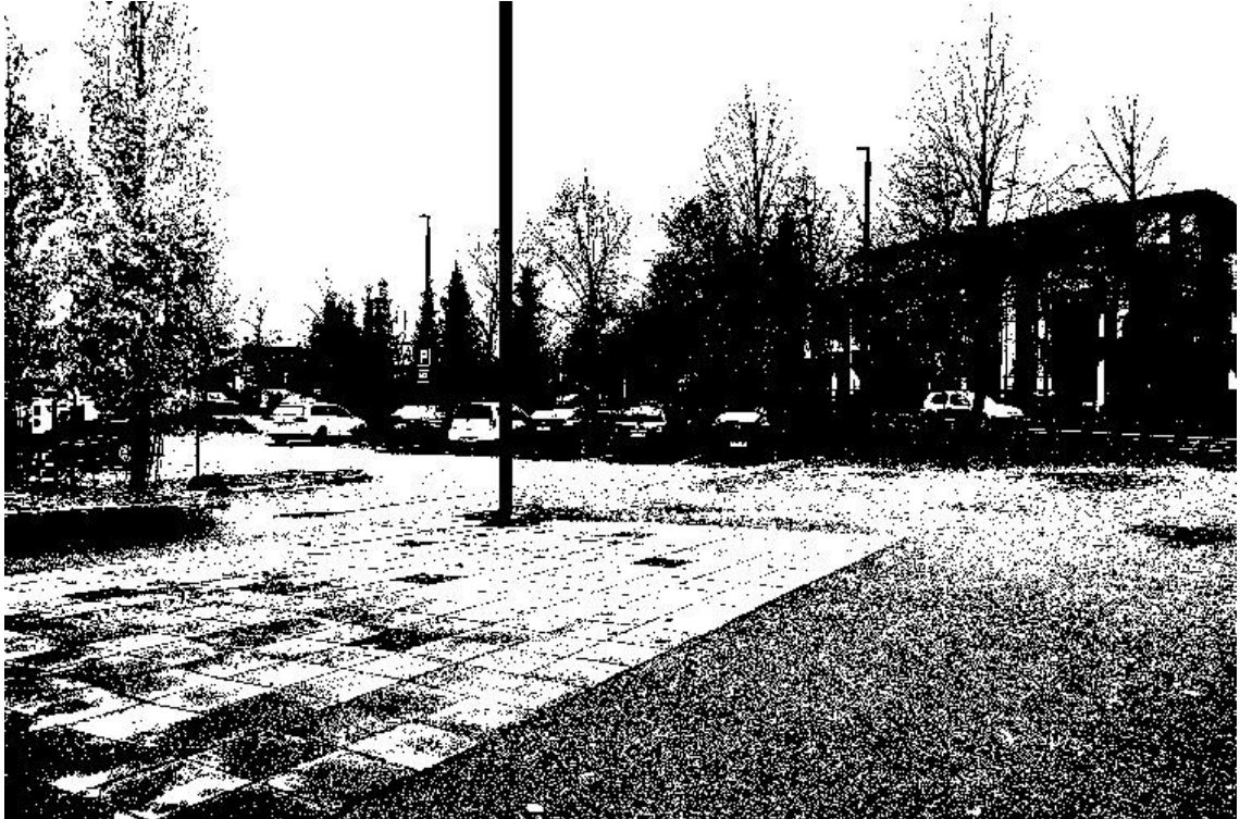
Kuva 3. Binäärikuva. Kuvassa on enää raja-arvon perusteella määritelty mustat ja valkoiset pisteet. Huomataan esimerkiksi laatoituksen pintakuvio. Yksittäisien laattojen reunat erottuvat mustana, jolloin kuvioinnin perusteella voidaan määrittellä tarkastelusuuntaa
