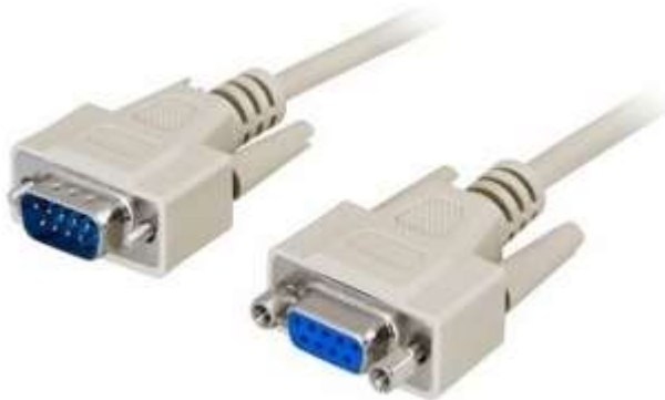
KUVA 7. 9-pinnisen RS-232 kaapelin liittimet (12)
