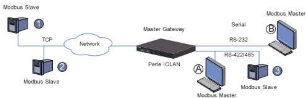
KUVA 11. Esimerkki Modbus master gateway tapauksesta (20)
