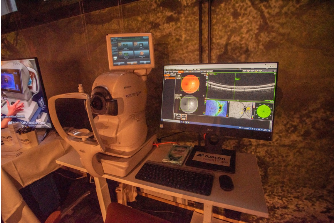
KUVIO 5. Esimerkki OCT-laitteesta. Kuvassa Topconin valmistama 3D OCT-1 Maestro2. Kuva: Jasmin Sakko
