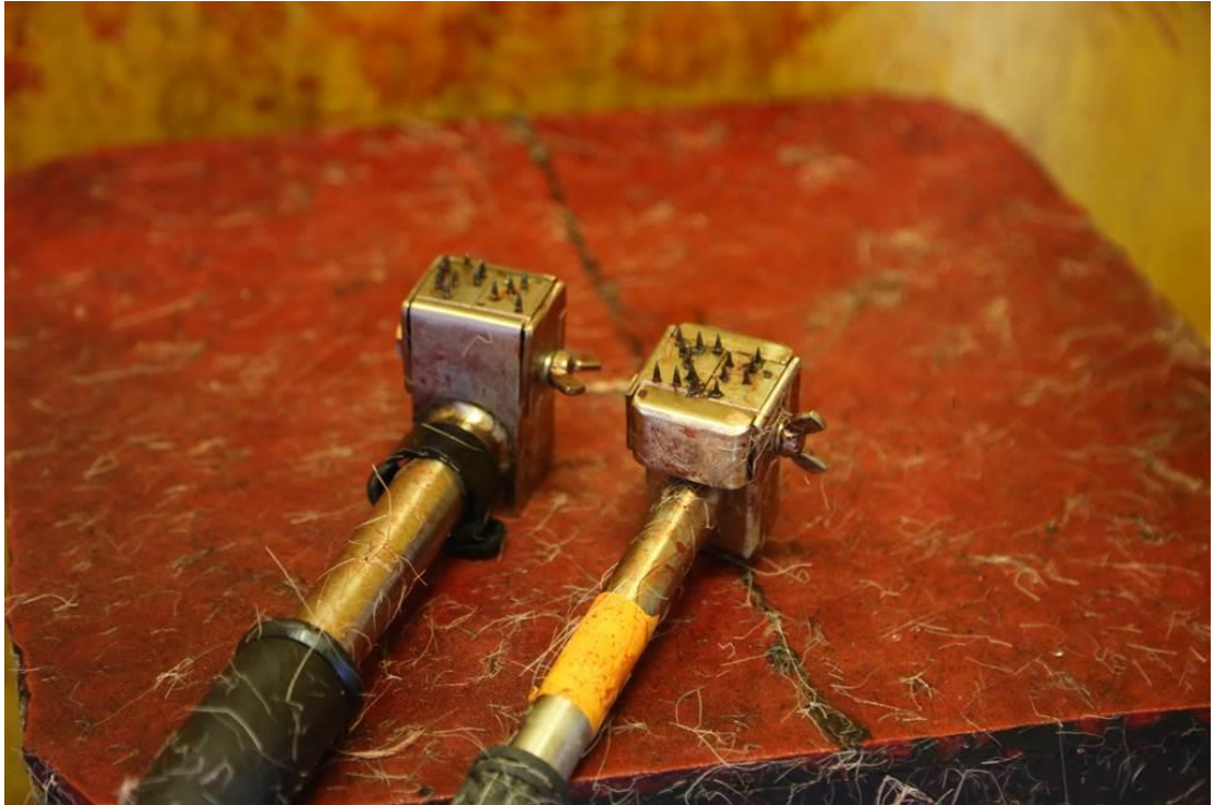
Kuvio 9. Leimaamiseen käytettävä työkalu (Kuva: Karoliina Majuri)
