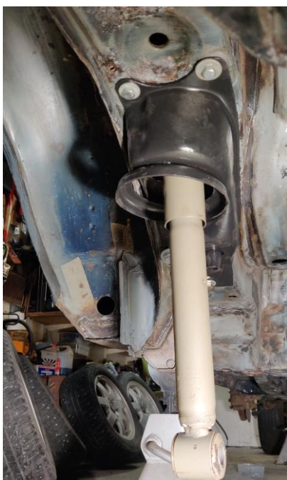
KUVA 19. Akseliston korikiinnike ja heilahduksenvaimennin
