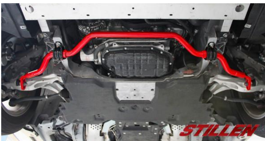
KUVA 8. Akselirakenne, jossa punaisella esitetty kallistuksenvakaaja (Stillen n.d.)
