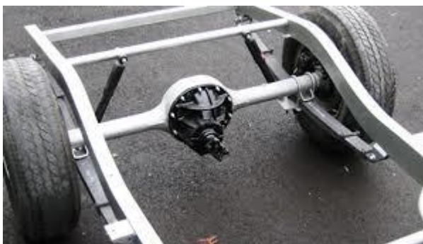
KUVA 12. Pitkittäinen lehtijousi (Superior Glass Works n.d.)
