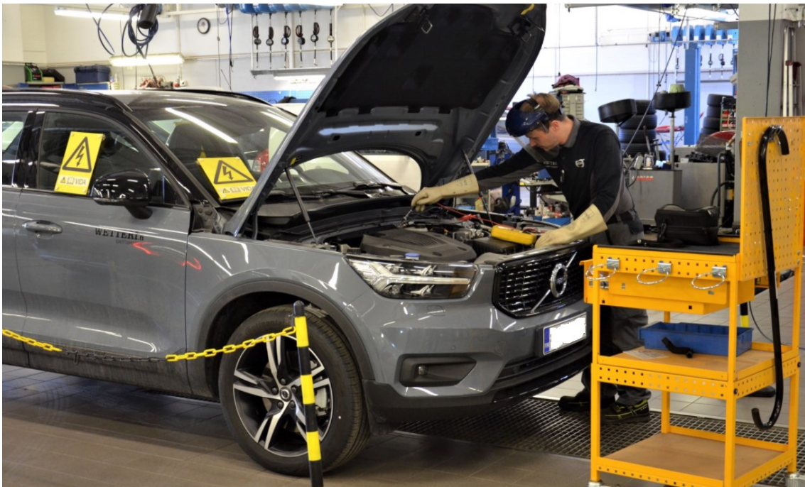
KUVA 2. Sähköauton työympäristön eristäminen (Kangas 2020.)
