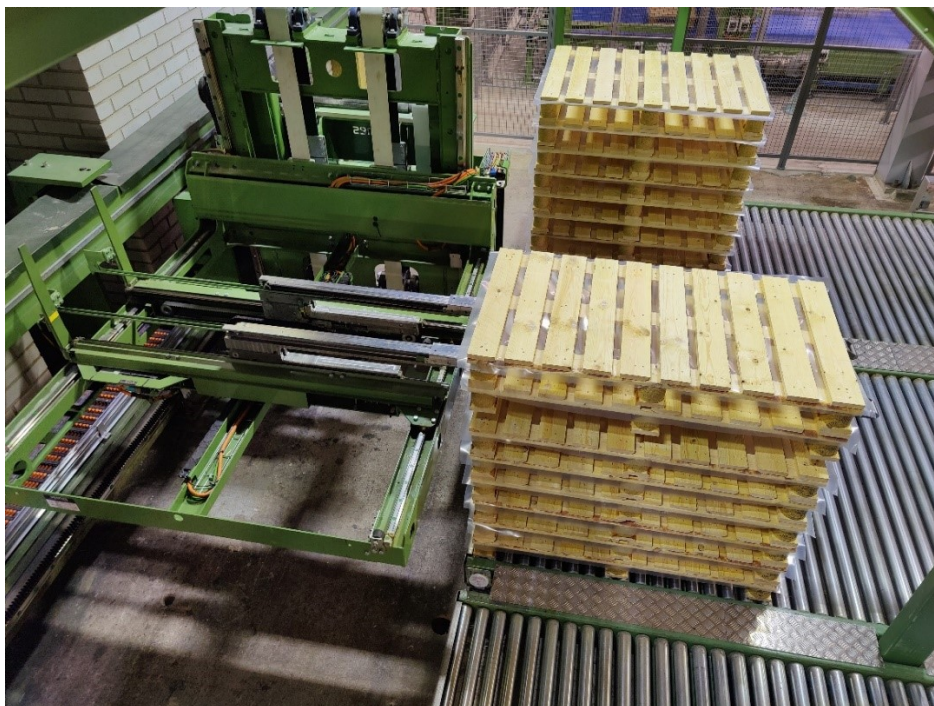
Kuva 11. Lavansyöttölaitteen lavojen kyytiinotto
