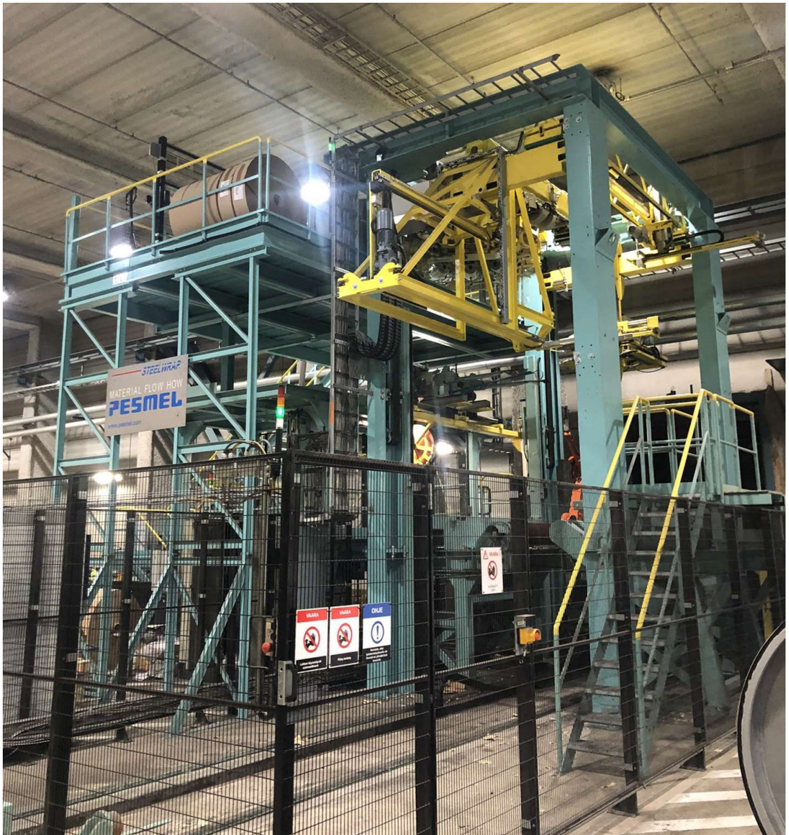
Kuva 20. RAP5-linjan modernisoitu käärintäkone 2.
