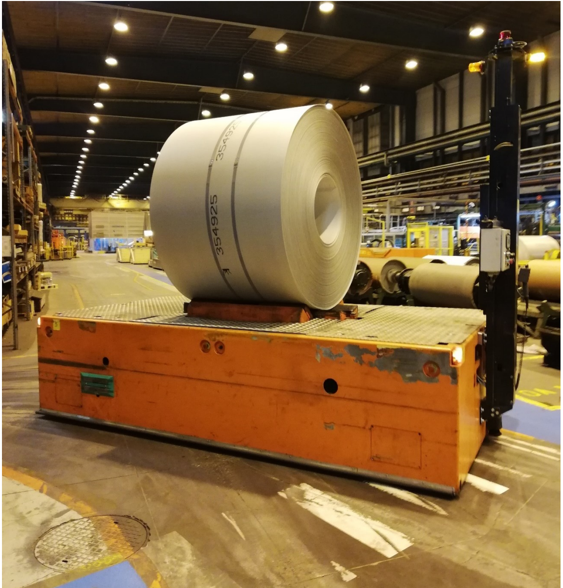
Kuva 25. Taakkaa selässään kantava rullaviivaunu.
