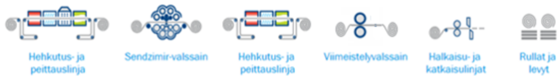
Kuva 3. Kylmävalssaamo 1:n prosessikaavio (Outokumpu Oyj 2021b.)
