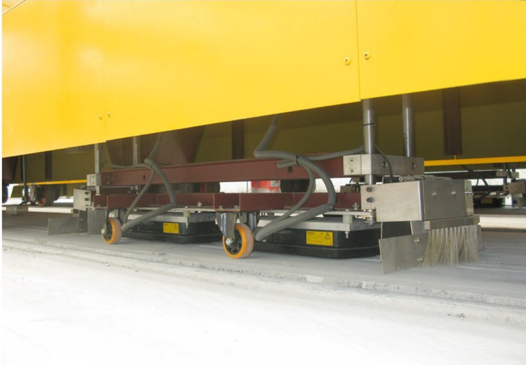
Kuva 38. Lähikuva lattiaan asennettavasta IPT-järjestelmän tehovastaanottimesta. (Conductix-Wampfler 2021a.)
