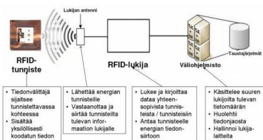
Kuva 2. Rfid-järjestelmän kuvaus (Hokkanen & Virtanen, 2018, 90).
