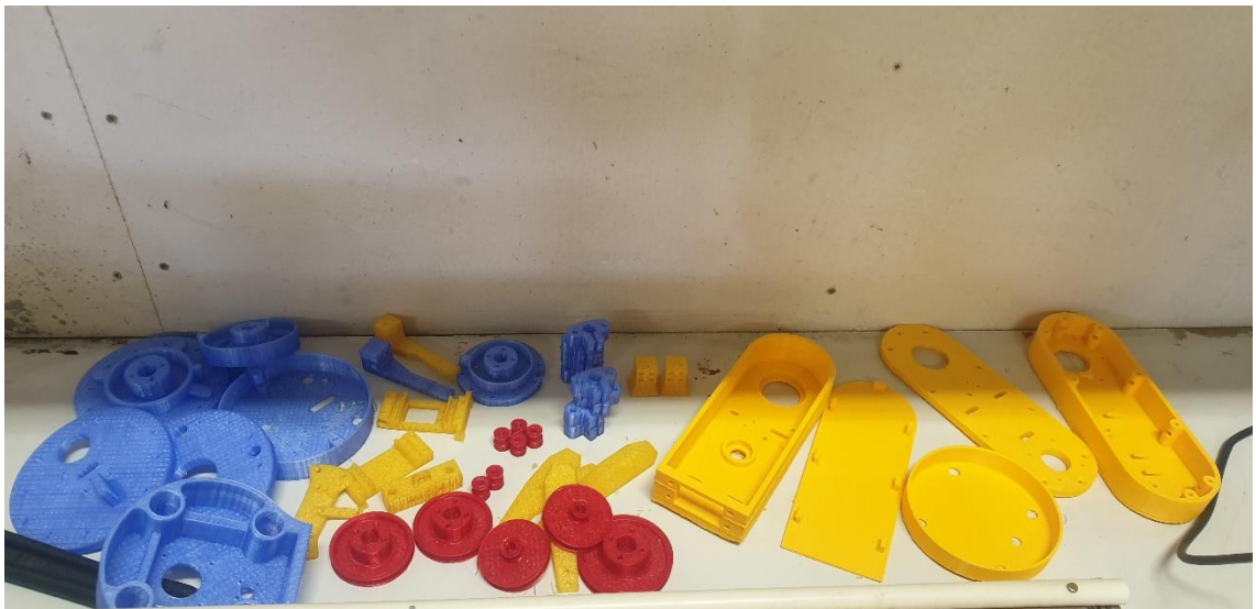
Kuva 9. SCARA-robotin osia oikea PETG ja vasen PLA
