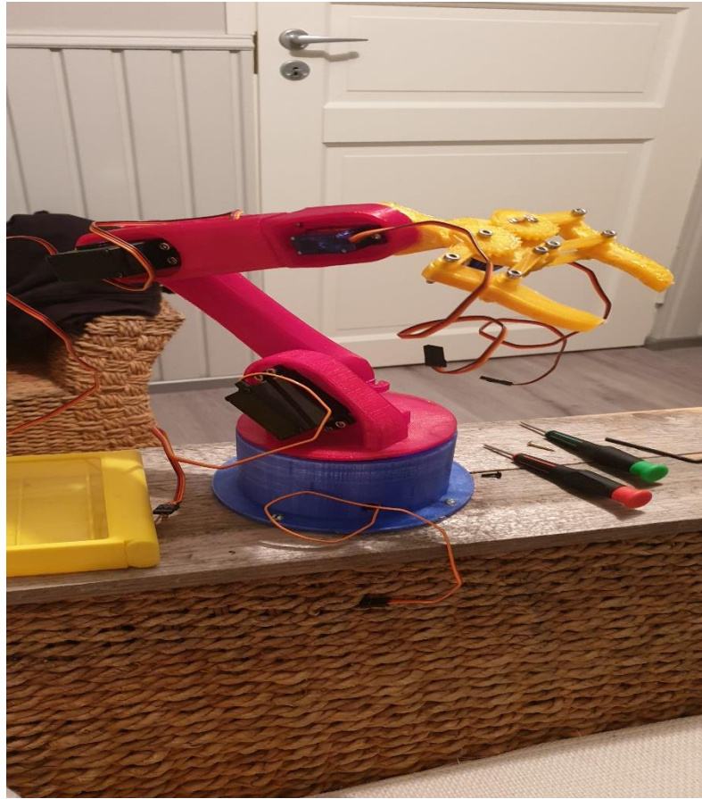
Kuva 16. Robotin servojen asennus
