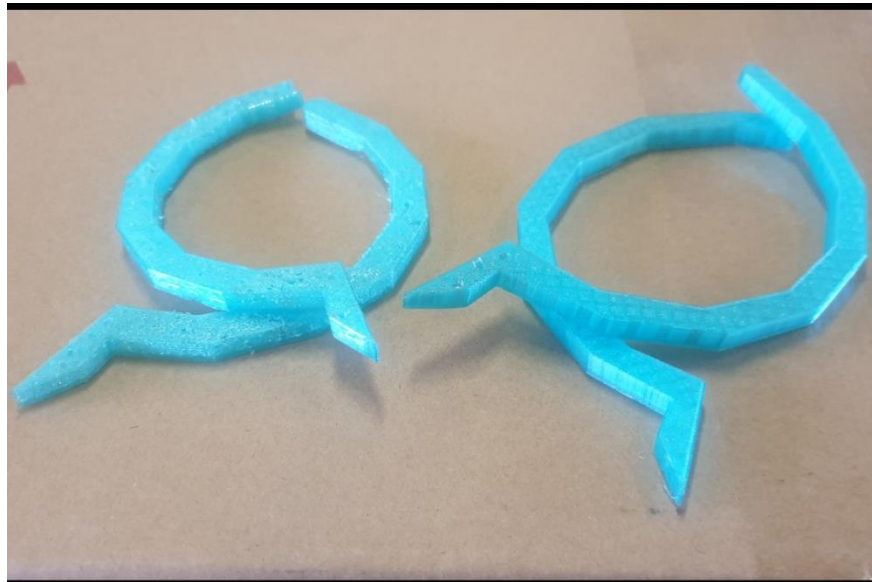
Kuva 11. CPE kappaleet vasen normaali nopeus ja oikea \frac{1}{2} nopeus
