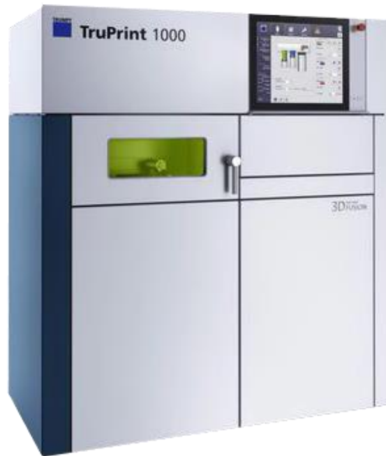
Kuva 8. Trumpf TruPrint 1000 SLM-tulostin. (btech b)
