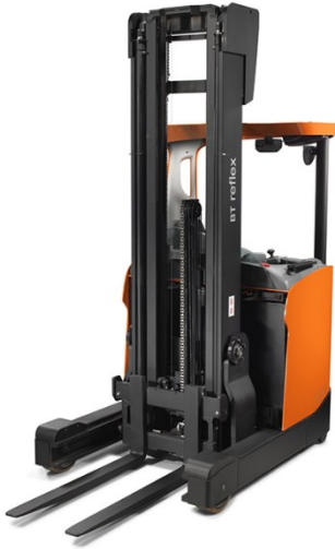
Kuvio 8. Työntömastotrukki BT Reflex
