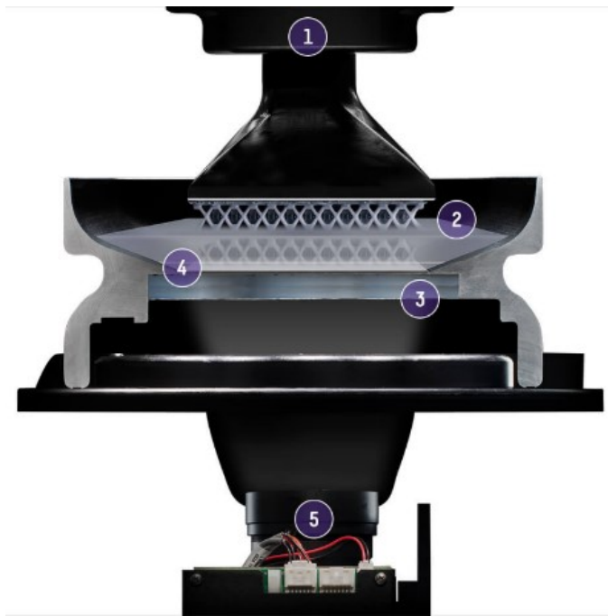
Kuva 6. Kuvaus Carbon3D:n CLIP-tekniikan tulostimen toiminnasta (Carbon 2021 B). Kuvaselitys: 1. Tulostuspeti 2. Resiini 3. Happea läpipäästävä allas/ikkuna 4. Kuollut alue/Dead zone 5. UV-valonlähde.
