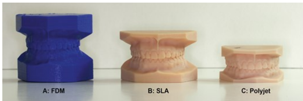
Kuva 2. Vertailu eri tulosteista tekniikoilla FDM, SLA ja polyjet (Rebong, Stewart, Utreja & Ghoneima 2018).
