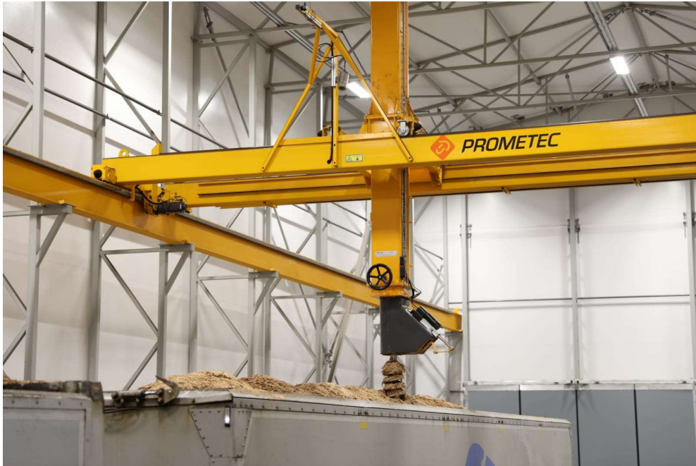
Kuva 11. Prometec Oy:n Q-Robot näytteenottorobotti (Kuva ja lupa: Prometec Oy / Henna Karlsson).
