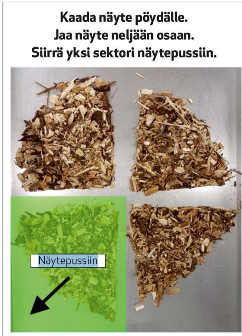
Kuva 14. Polttoainenäytteen pienentämisen eli neliöinnin ohje (kuva ja lupa Loimua Oy).
