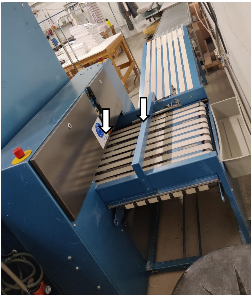
Kuva 12. Niputtaja taittokoneen sivussa. Päällimmäinen hihnasto liikkuu sivuttain sylinterien ohjaamana. Nuolet kertovat missä valokennot sijaitsevat.
