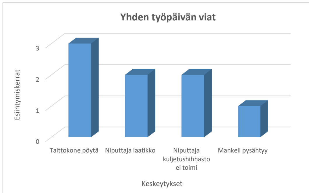
Kuvio 3. Työpäivän 8.11.2021 aikana tapahtuneet keskeytykset mankeliinjastossa. Tarkkailu kuuluu osaksi laadunvalvontaan.
