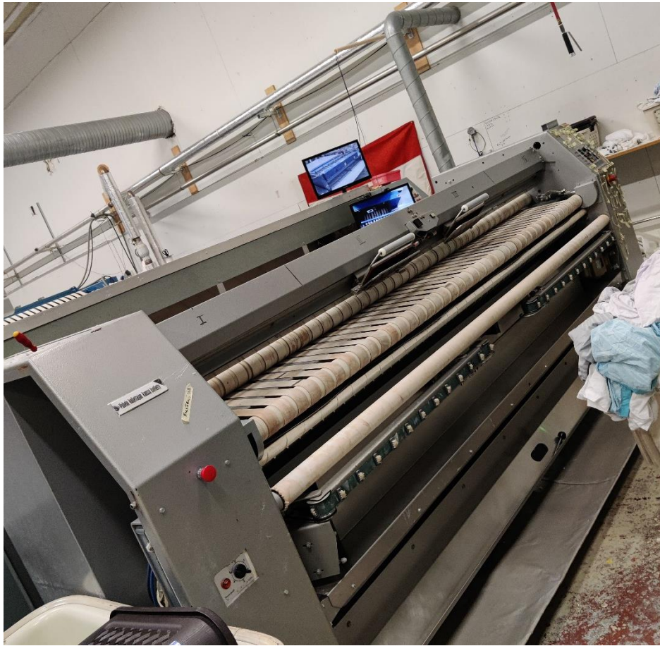
Kuva 7. Syöttökone vuodelta 1986. Eri syöttötoimenpiteitä varten.
