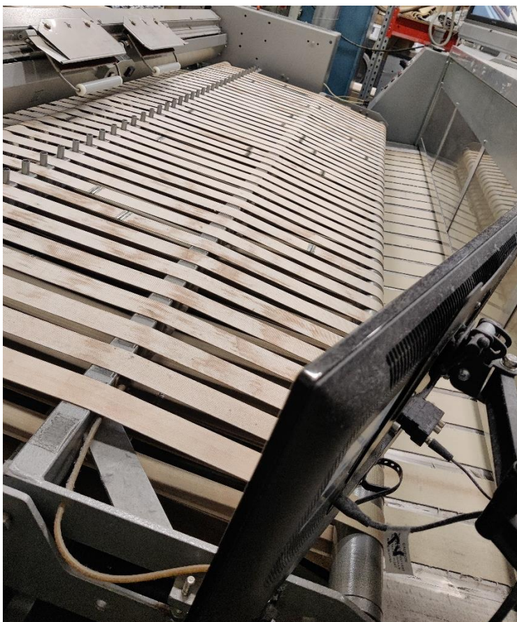
Kuva 8. Syöttökoneen hihnasto ja alla syöttöpöydän leveämpi hinnasto.
