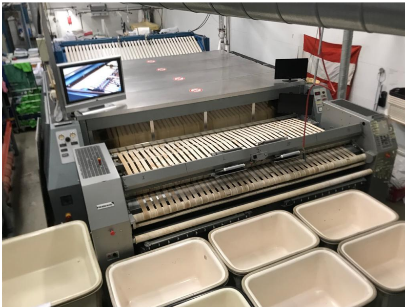
Kuva 2. Mankelilinjastossa ensimmäisenä syöttöpöytä, keskellä mankeli ja takana taittokone (sininen). Mankeli on vuodelta 1992.
