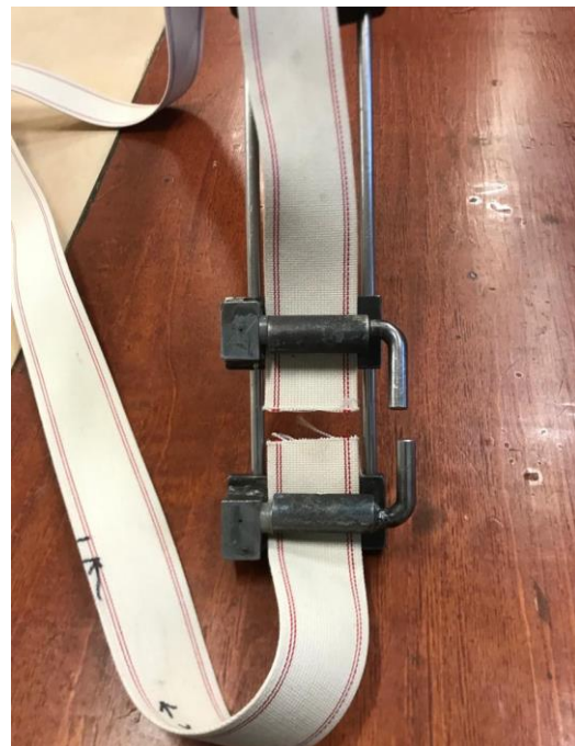
Kuva 25. Hihnojen yhdistäminen liitoskoneella.
