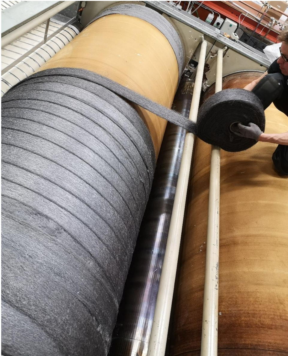
Kuva 18. Kouruja puhdistetaan teräsvillalla.
