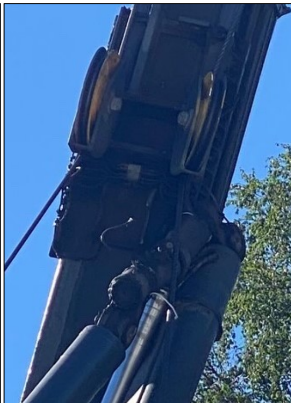
Kuva 5. Yläluistin repeämä (Jira, JSD)
