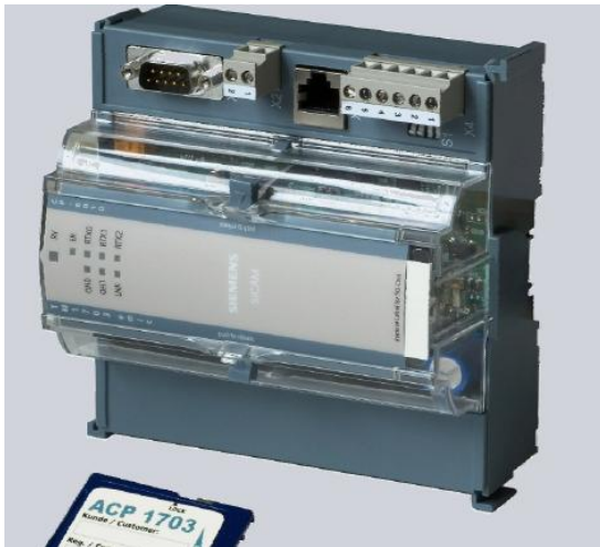
KUVA 15. SIEMENS TM 1703 -ala-asema (SIEMENS 2012)
