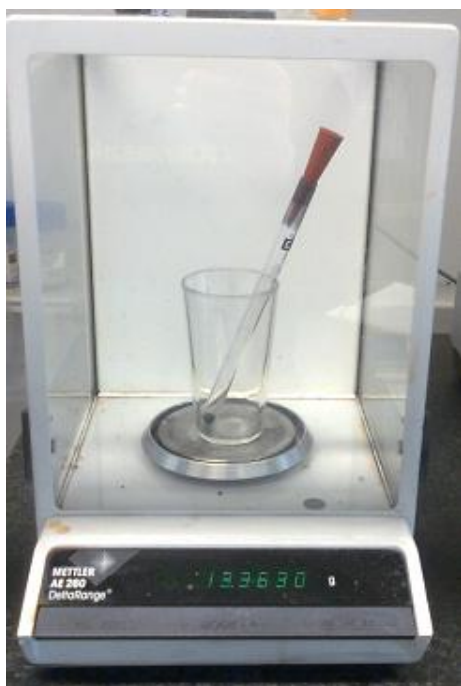
KUVA 7. Mettler AE 260 Delta Range, putken mittaus käynnissä
