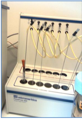
KUVA 8. Esikäsittelijä. Yksi testiputki odottaa lämmitykseen menemistä. Näyteputken ja sen tulpan välistä menee typen syöttöputki
