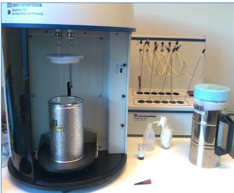
KUVA 9. Analysaattori. Oikeanpuoleisessa putkessa on näyte valmiina (vasen putki on referenssiputki) ja nestetyppi on termoksessa. Esikäsittelijässä (taustalla) on toinen näyte lämmityksessä
