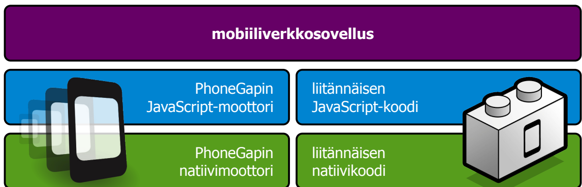
Kuva 3. PhoneGapin tarjoaman valmiin moottorin ja liitännäisen välinen arkkitehtuuri.
