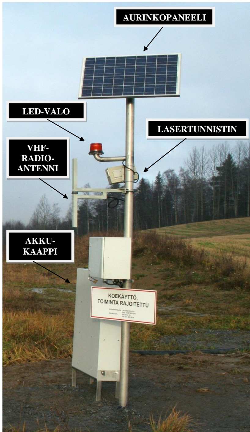
Kuva 6. Vartioimattoman rautatien tasoristeyksen huomiolaitteen prototyyppi
