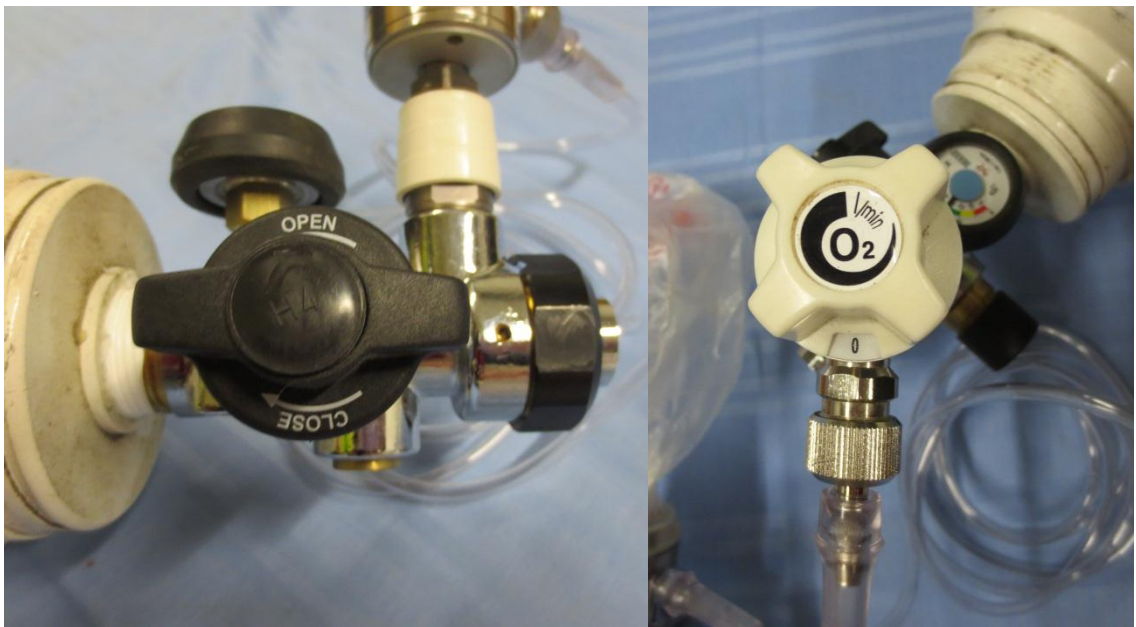
Kuva 47. Happipullon avausventtiili ja happivirtauksen säätö.
