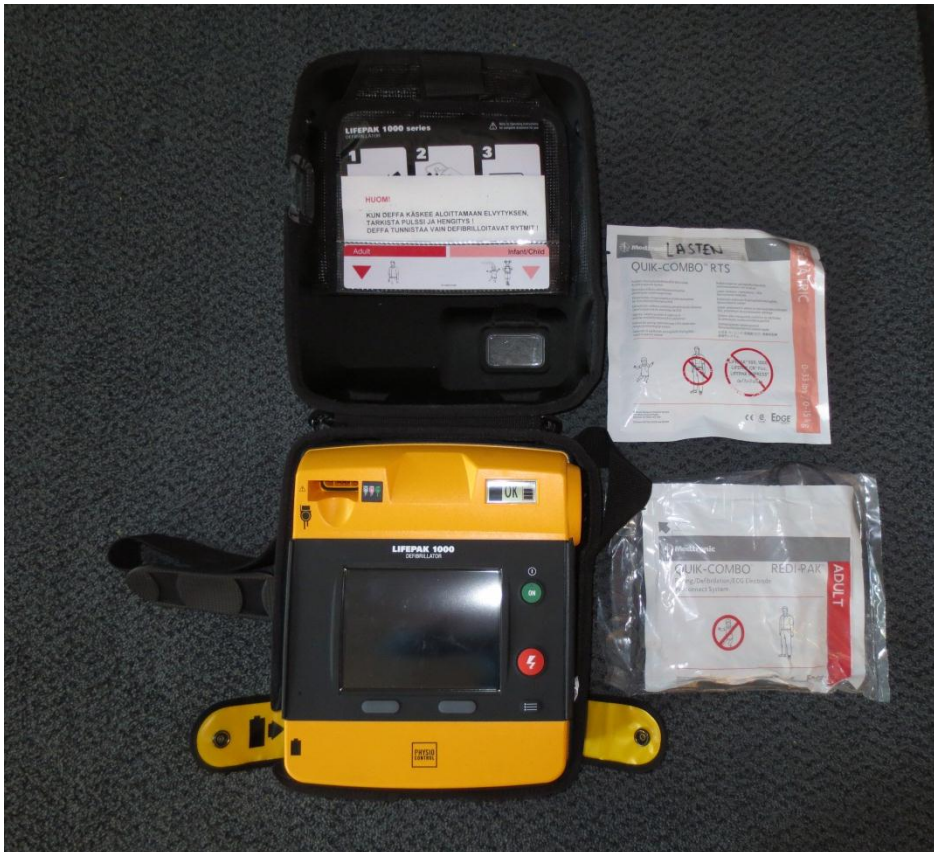
Kuva 8. Puoliautomaattinen defibrillaattori ja aikuisten- ja lasten iskulätkät.
