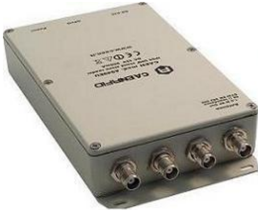
KUVIO 7 Caenin UHF-lukija teollisuuskäyttöön (RFID Equipment 2006c)
