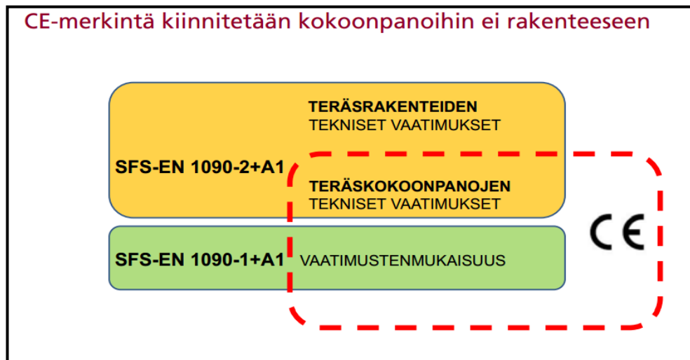
Kuva 9. CE-merkinnän kiinnittämisen periaate /19/
