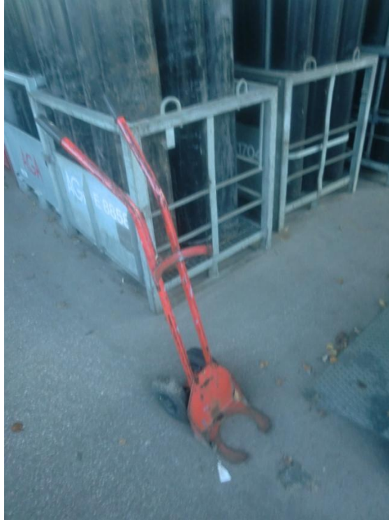
Kuva 2. Yhden pullon kuljettamiseen suunnitellut pullokärryt.
