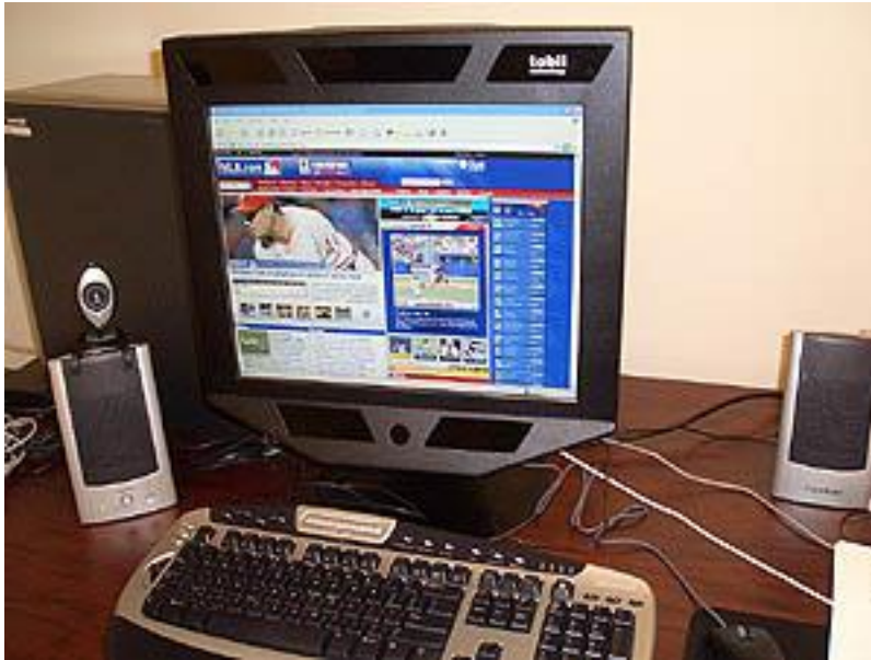
Kuva 7. Nielsenin ja Pernicen käyttämä silmän liikkeitä seuraava testilaitteisto (Nielsen, Pernice 2010)
