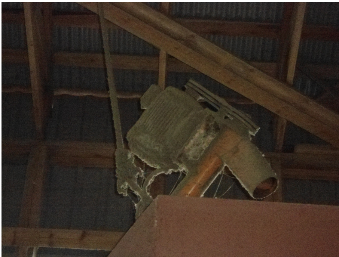
Kuva 2. Pölyinen moottori hankalasti siivottavassa paikassa.
