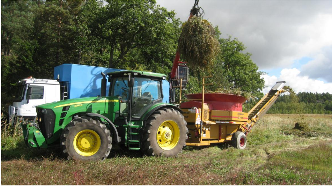
Kuva 7. Niitetyn järviruo'on silppuaminen (Terhi Ajosenpää 2012).
