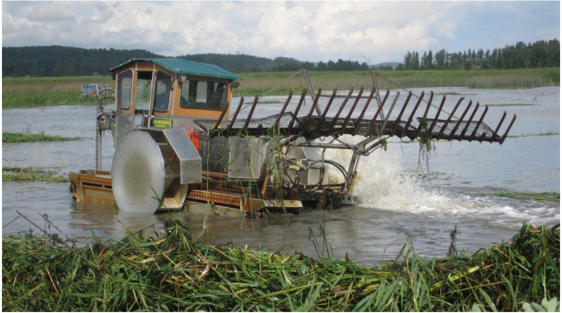
Kuva 4. Korjuussa käytettävä kelluva Truxor-leikkuulaite (Terhi Ajosenpää 2012).
