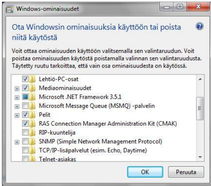
KUVA 10. CMAK -ohjelmiston asennus 32-bittiseen Windows 7 -työasemaan
